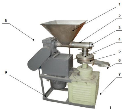
Рис. Установка для тонкого измельчения сырья с шнековым питателем: 1 – загрузочный бункер; 2 – корпус шнекового питателя; 3 – крышка; 4 – загрузочная горловина; 5 – корпус ножевой головки; 6 – разгрузочный гусак; 7 – рама; 8 – привод шнекового питателя; 9 – привод ножевого механизма
