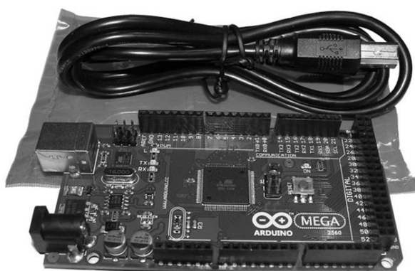
Рисунок 4. Платформа Arduino Mega-2560
