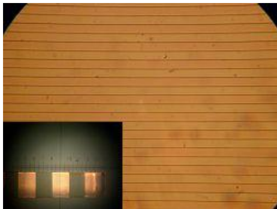
Рисунок 4. Вид периодических структур, нанесенных на кристаллическую пластинку с использованием фоторезиста
