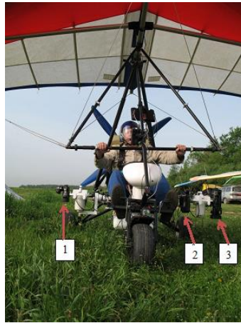
Рис.1 «Биосфера НТ»: высокая степень автоматизации летно-съёмочных работ обеспечивается применением электронных систем управления поворотными платформами правого и левого борта на которых размещены: профессиональная цифровая камера (1); тепловизор (2); трехматричная профессиональная видеокамера (3).
