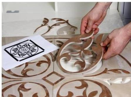
Рис. 1 Сопряжение элементов керамической облицовки изготовленных с применением технологии фигурной резки
