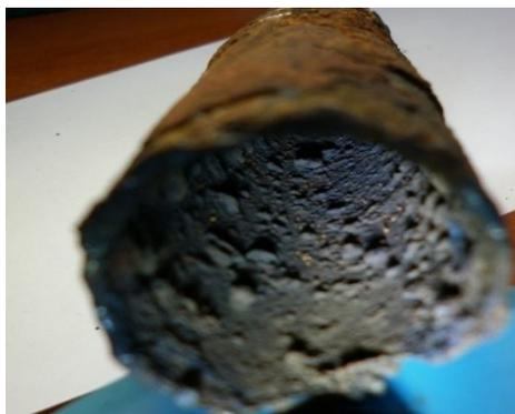
Рисунок 3 - Отложения на внутренней поверхности трубы
