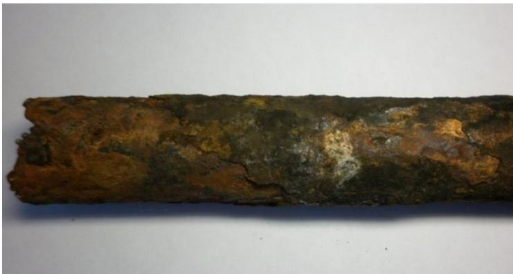
Рисунок 2 Элемент трубы из котельного пучка котла КВ-0,4
