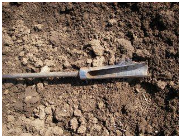
Рисунок 4.1 – Наконечник бура для забора проб длиной 60-100 см [43].
