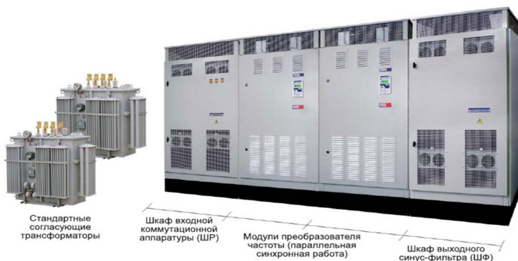
**Рисунок 8 – Высоковольтный преобразователь частоты для регулирования производительности электронасосных установок**
