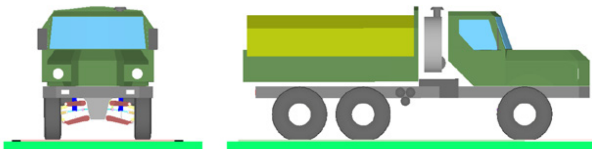
Положение автомобиля в момент начала торможения. t = 0 с, угол продольного крена подрессоренной массы 0^\circ
