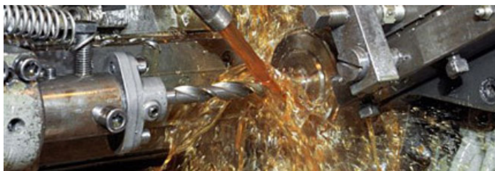
Рис. 1. Процесс сверления отверстия с использованием СОТС
