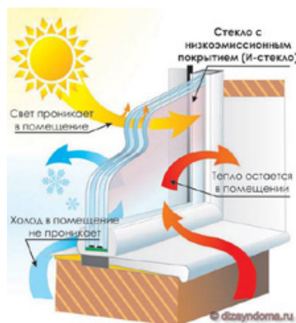
Рис. 2. Действие низкоэмиссионного стекла
