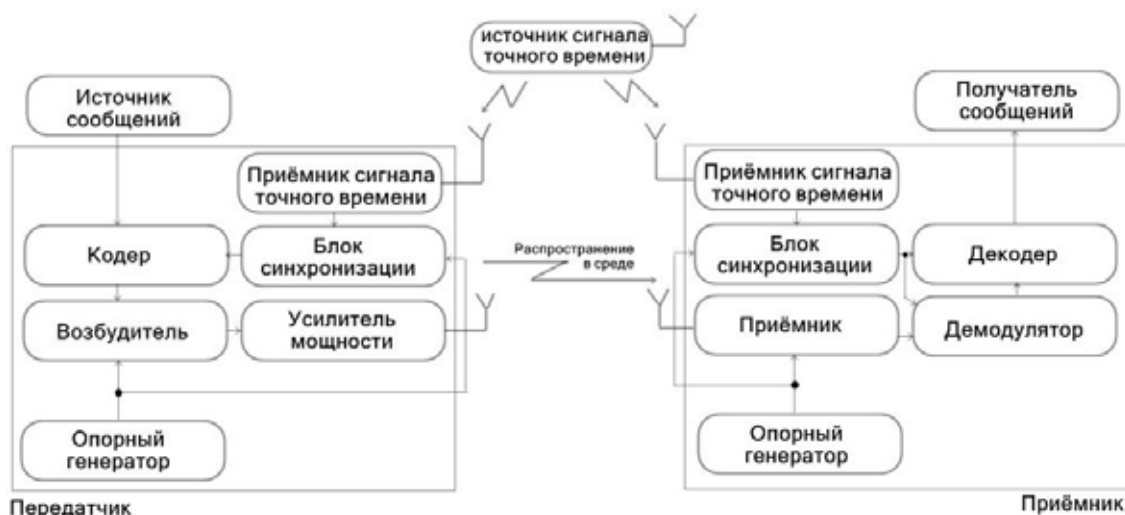
Рис. 1. Структурная схема системы синхронизации по абсолютному точному времени
