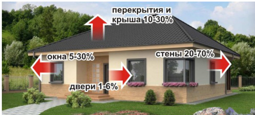
Рис. 1. Распределение теплотерь в здании
