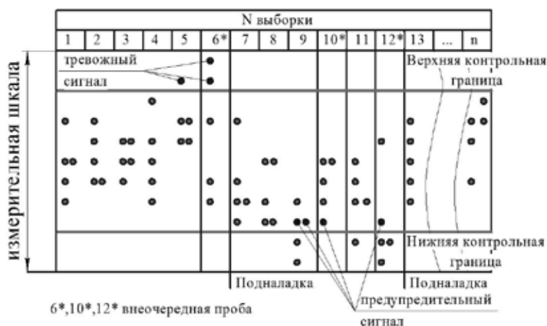
Рис. 1. Точечная диаграмма для контроля устойчивости технологического процесса посредством выборок
