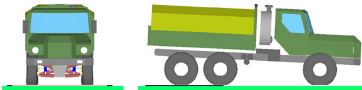
Положение автомобиля в момент полной остановки. t = 3.5 с, угол продольного крена подрессоренной массы 2.1^\circ
