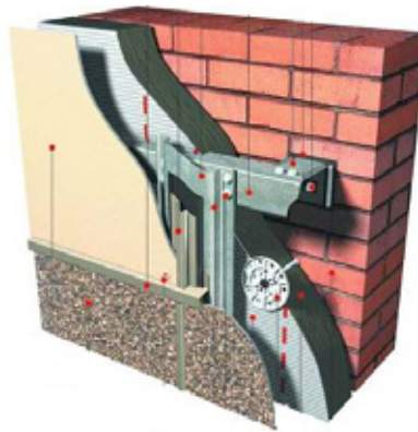
Рис. 1. Общий вид вентилируемого фасада установленного на кирпичную стену
