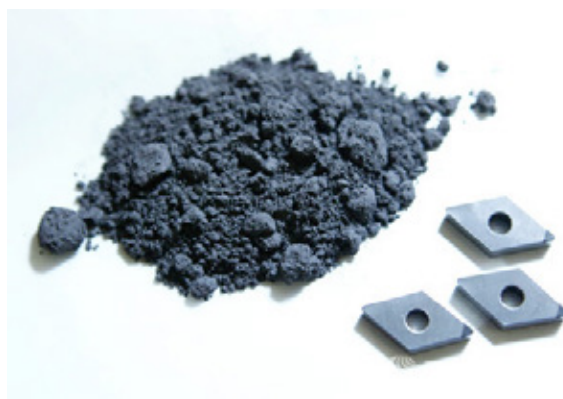
Рис. 4. Порошок кубического нитрида бора в виде режущей массы и конечная продукция компании — технологичные СМП по металлу
