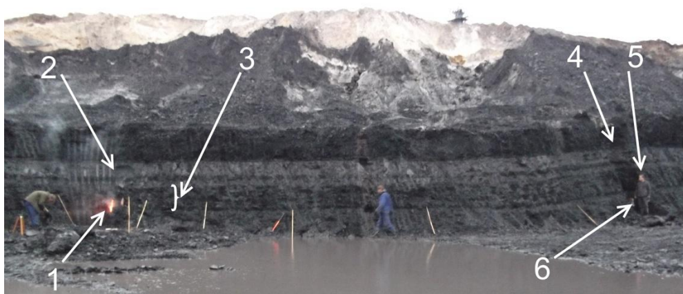
Рисунок 2- Внешний вид фрагмента забоя при проведении эксперимента по акустической диагностике очага пожара в промышленных условиях: (обозначения те же, что на рисунке 1)
