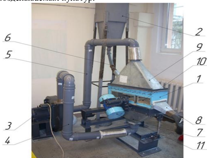
Рисунок 3 – Общий вид экспериментального стенда для изучения процесса разделения зерновой массы по удельной плотности
