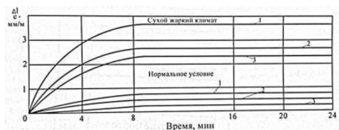
Рисунок 3 - Кинетика изменения начальной пластической усадки ( V/C=0,50 ; расход цемента-370 кг/м 3 ). 1 1 и 1-без добавки; 2 1 и 2-с добавкой-0,40%; 3 1 и 3-с добавкой-0,60%.
