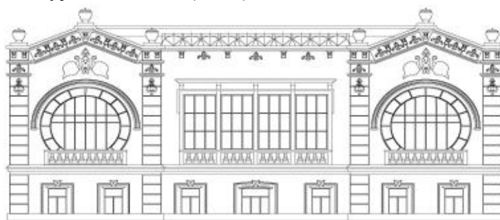
Рис.3 Петропавловск. Дом купца Халита Янгуразова. Реконструкция фасада дома. Вып. Мухамеджанова И.
