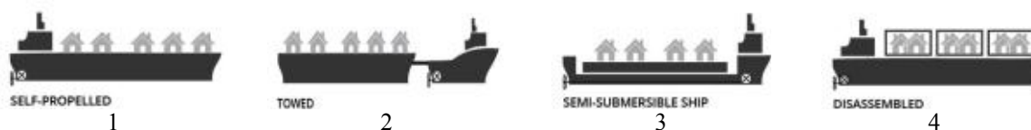
Рис.1. Зависимость между подвижностью плавучих городов и способом их транспортировки: 1 – самоходные конструкции наиболее подвижны, но не эффективны при редких перемещениях; 2 – отбуксировка и 3 – перевозка на полупогружных судах обеспечивают лучшее соотношение подвижности и экономичности эксплуатации, 4 – перевозка в разобранном виде требует наибольших затрат времени [6]
