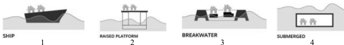
Рис.3. Зависимость между мореходными качествами плавучего города и степенью комфорта жителей в суровых условиях водной стихии: ситуации 1 – «на корабле» и 4 – «под водой» менее предпочтительны; ситуации 2 – «на приподнятой платформе» и 3 – «в уровне воды между волнорезами» более предпочтительны [6]
