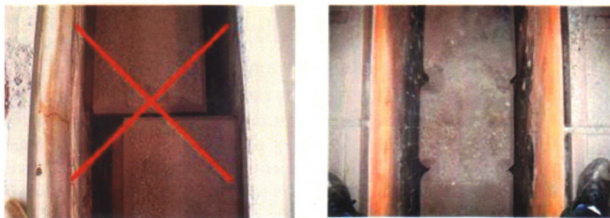
Рисунок 3 — Ненадлежащая загрузка анодов (слева); с неравномерным распределением пересыпочно́го материала и правильной загрузкой (справа).
