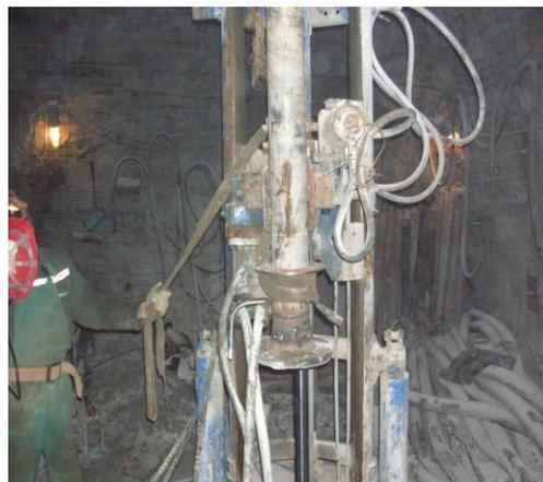
Рис. 3. Установка кондуктора дренажной скважины.
