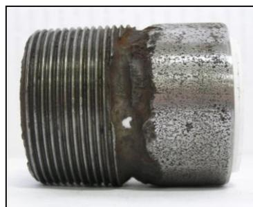
Рис. 1. Фрагмент трубы, подвергшейся ускоренной коррозии вследствие соединения с коррозионно-несовместимой муфтой.
