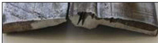
Рис. 3. Коррозионное разрушение трубы вследствие электрохимической неоднородности металла трубы и сварного шва
