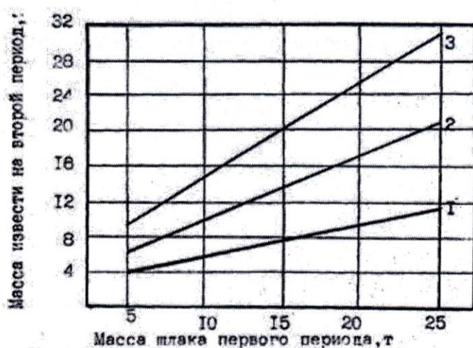
1 – основность конечного шлака 3,0; 2 – основность конечного шлака 4,0;
