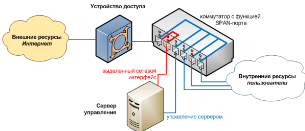
Рисунок 12 – ИспользованиеEthernet – коммутатора с возможностью зеркалированияSPAN портов
