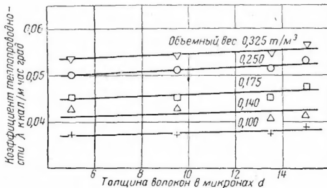
Рисунок 2.9 - Влияние толщины волокон на теплопроводность стеклянной ваты
