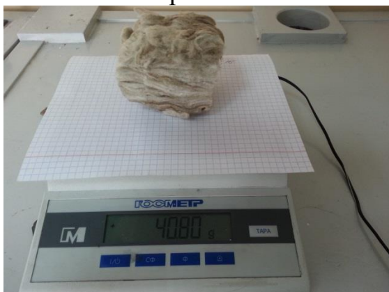
Рисунок 3.7 - Взвешивание образца базальтовой изоляции
