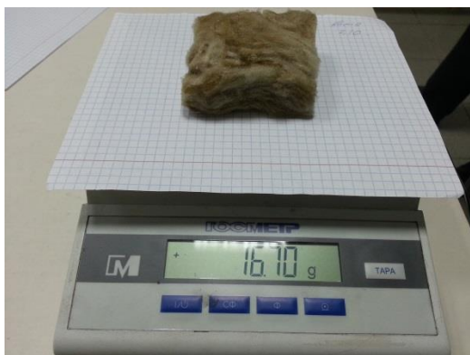
Рисунок 3.5 - Взвешивание образца минеральной ваты
