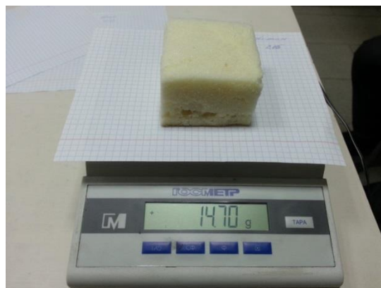
Рисунок 3.8 - Взвешивание образца полиуретана
