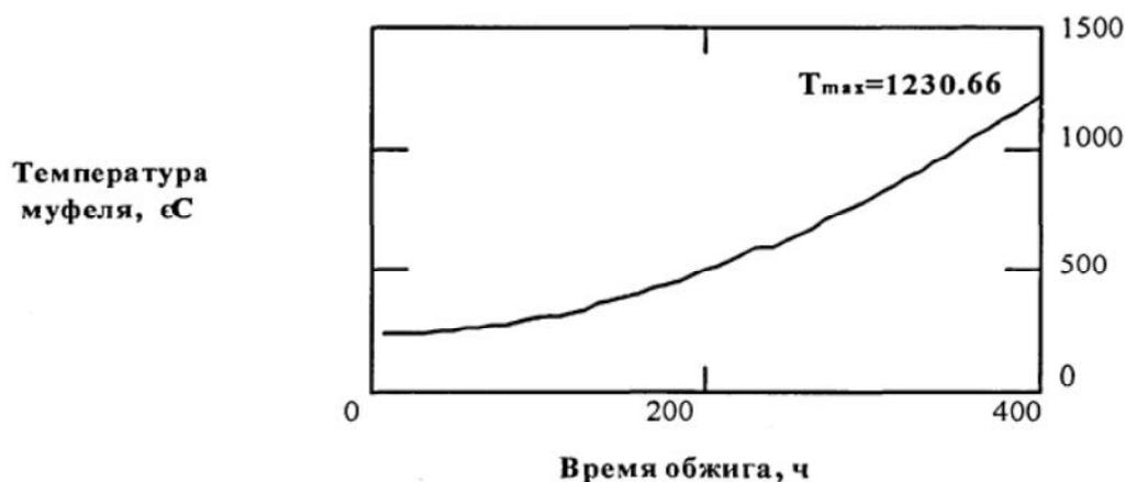
Рисунок 43 - Расчетная зависимость изменения температуры муфеля от времени обжига.
