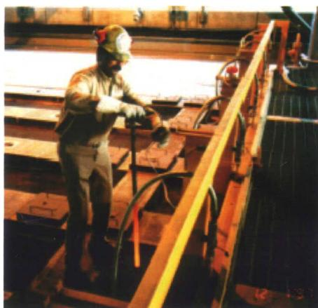
Рисунок 29 - Термопара, извлекаемая из газохода
