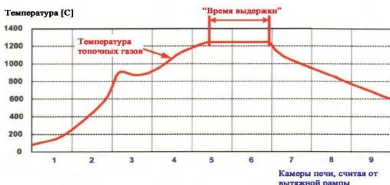
Рисунок 33 - Период времени с постоянной температурой топочного газа вместо времени выдержки анода
