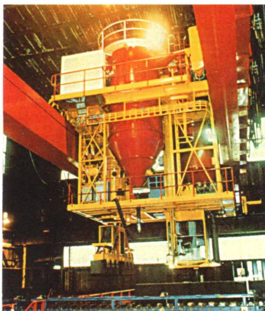
Рисунок 23 - Устройство отсоса пересыпки, установленное на кране печи обжига
