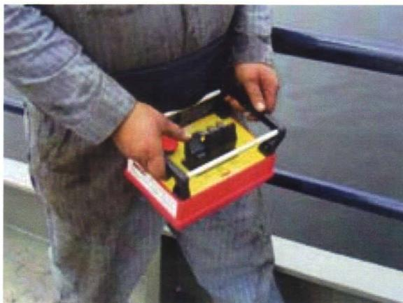
Рисунок 56 – Беспроводное устройство управления краном
