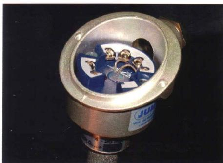
Рисунок 51 – Головной датчик для термопары
