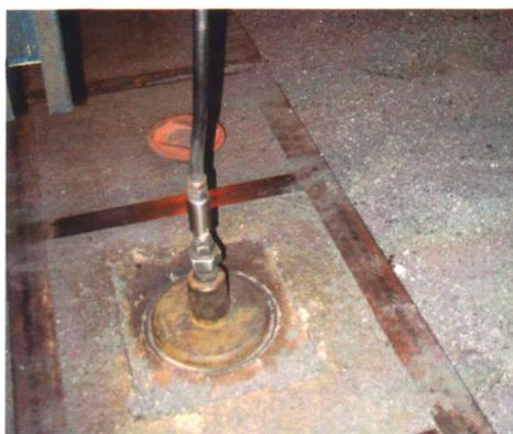
Рисунок 30 - Оптический пирометр, устанавливаемый в лючок
