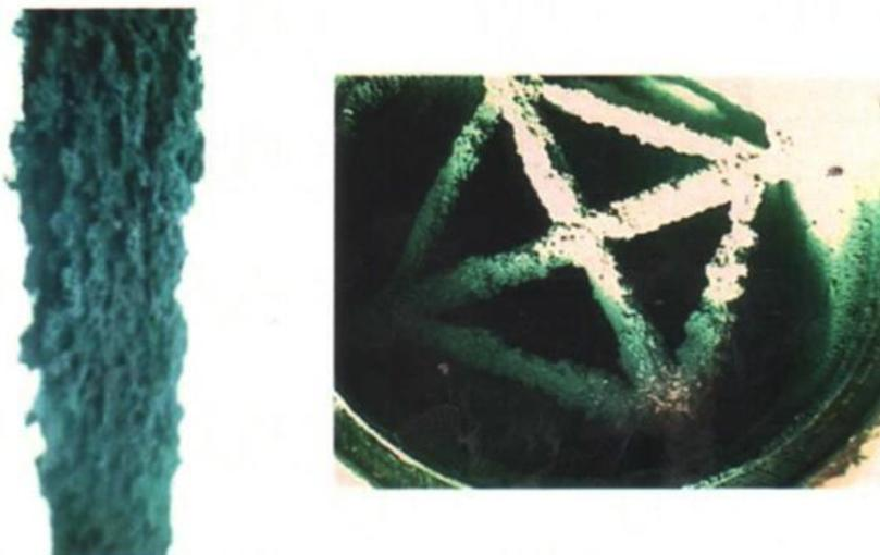
Рисунок 27 - Слева: отложения сажи на термопаре в первой камере на разогреве. Справа: отложения сажи в стояке обводного газохода.
