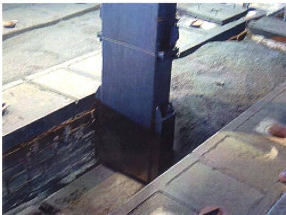
Рисунок 55 – Извлечение пересыпчного материала из кассеты для анодов
