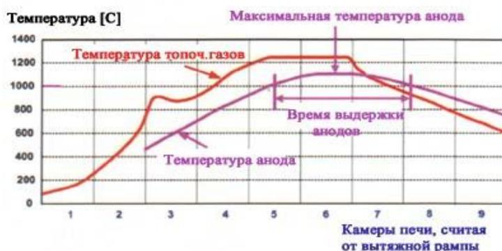
Рисунок 32 - Температура топочного газа, максимальная температура анода и время выдержки анода
