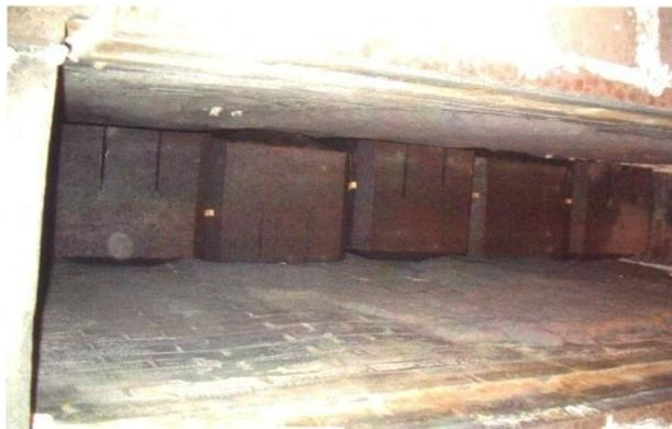
Рисунок 59 – Разделение анодов деревянными клиньями для предотвращения слипания
