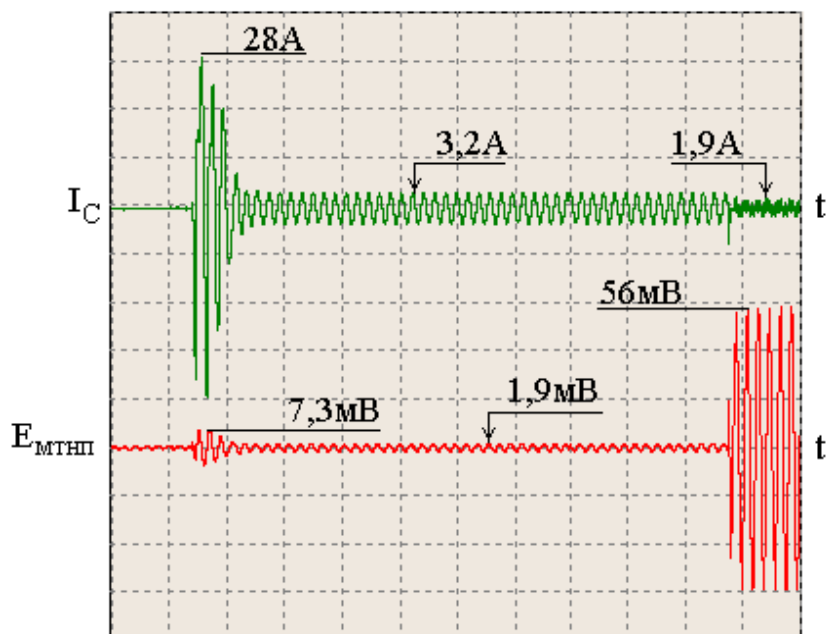
Рисунок 47 – Осциллограммы пуска, холостого хода и ОЗЗ АД АО-31-4
