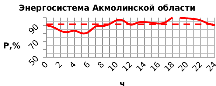
Рисунок 3.3 – Суточный график нагрузки (в % от пиковой нагрузки) энергосистемы Акмолинской области, зимний максимум (использовались данные института «Энергия») [61,68]
