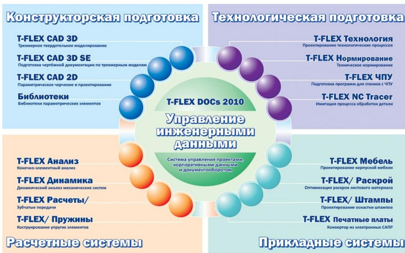
Рисунок 21 – Структура комплекса T-FLEX
