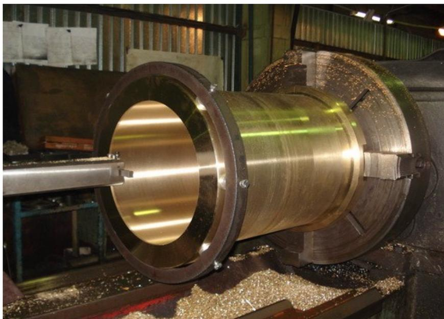
Рисунок 2 – Обработка детали на токарно-винторезном станке
