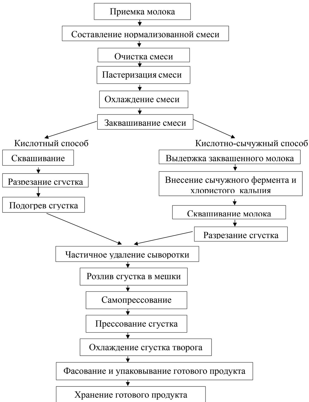
Рисунок 1. Схема технологической линии производства творога традиционным способом
