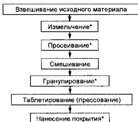
Для большинства фармацевтических препаратов технология производства таблеток состоит из следующих операций : взвешивания исходного материала, измельчения, просеивания, нанесение покрытия [21].
