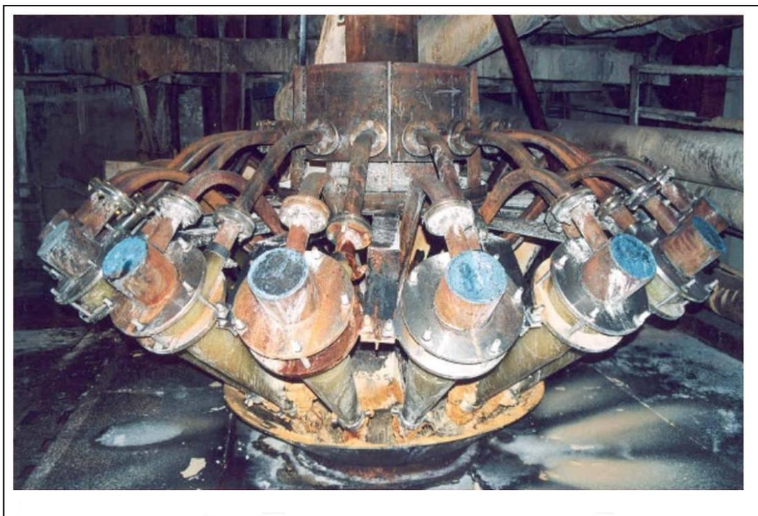
Рисунок 6 - Батарея гидроциклонов
