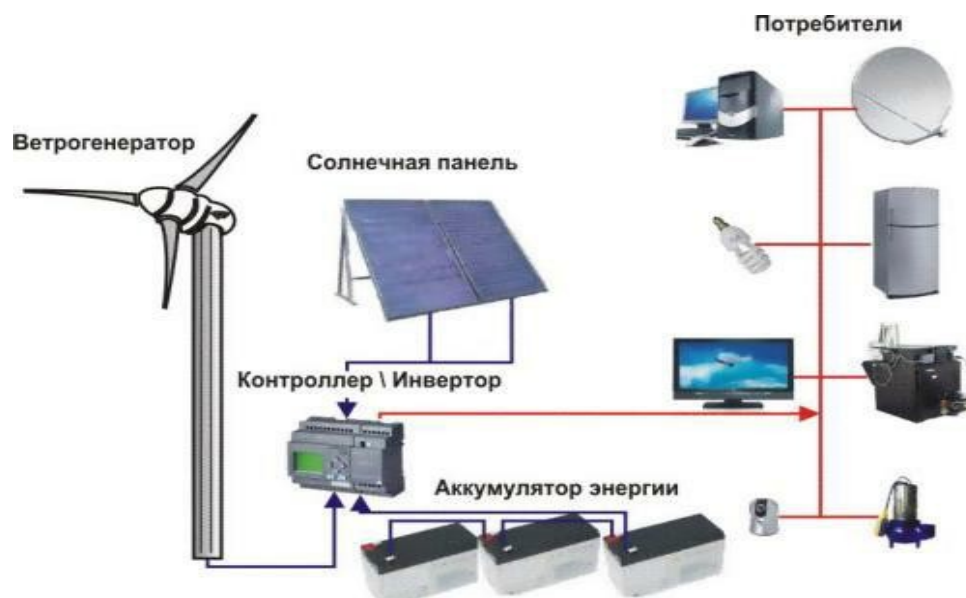
Рисунок 2.36 - Типовая схема гибридной ветро-солнечной системы
