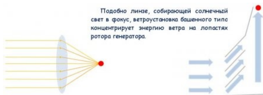
Рисунок 2.24 - Принцип концентрации энергии ветра в башенной ВЭУ
