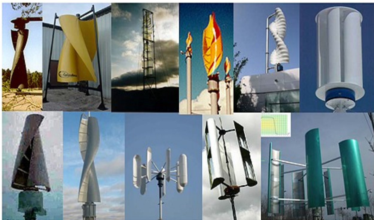
Рисунок 3.6 - Разнообразие конструкций ветродвигателей, работающих по принципу дифференциального лобового сопротивления
