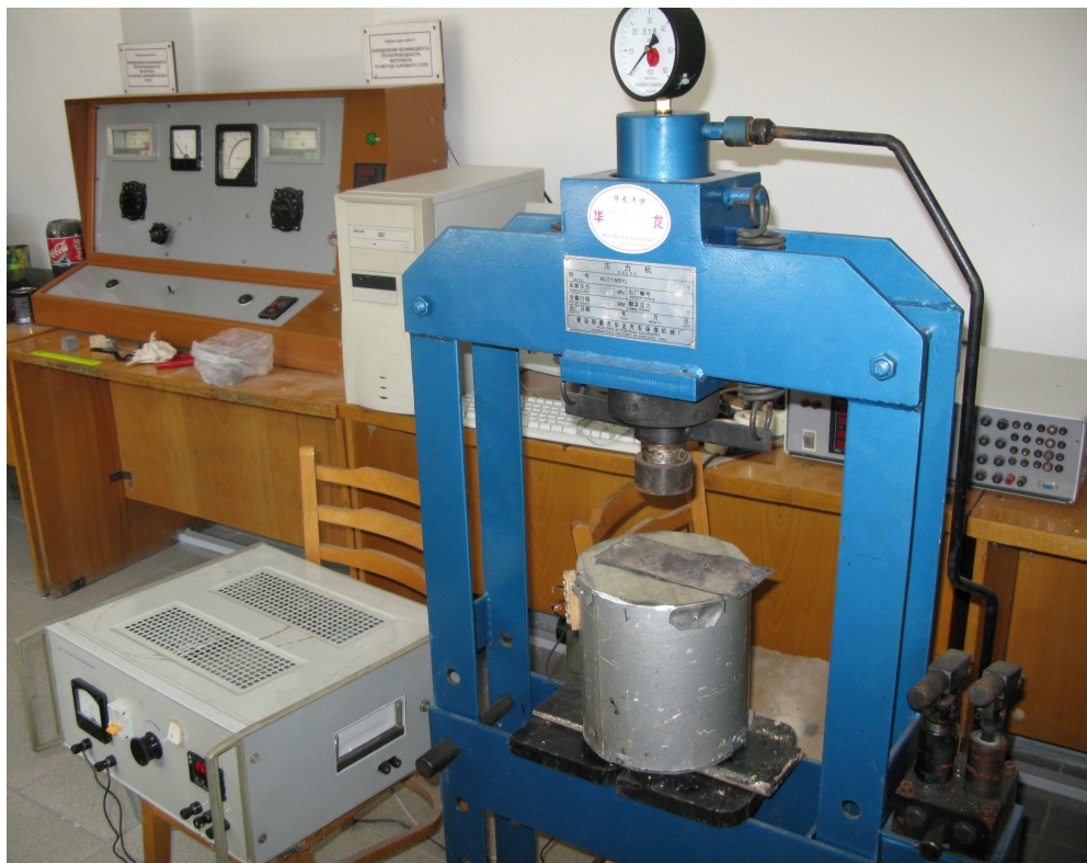
Рисунок 3.2 - Стенд для исследования зависимости предела прочности на сжатие от температуры
