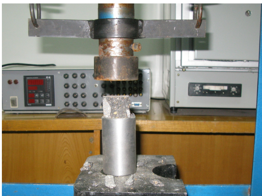
Рисунок 3.3 – Разрушение периклазоуглерода при комнатной температуре
