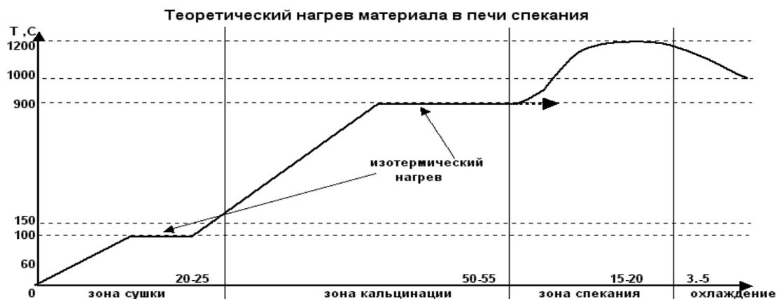
Рисунок 1.1 – Схема теоретического нагрева материала в печи спекания
