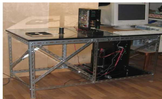
Рисунок 23 – Справа: многофункциональный импульсный тестер, слева: импульсный тестер концентраторных фотоэлектрических модулей.
