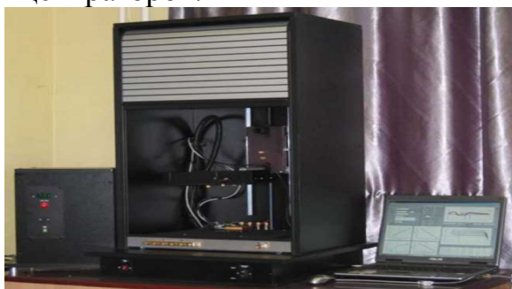
Рисунок 23 – Справа: многофункциональный импульсный тестер, слева: импульсный тестер концентраторных фотоэлектрических модулей.
