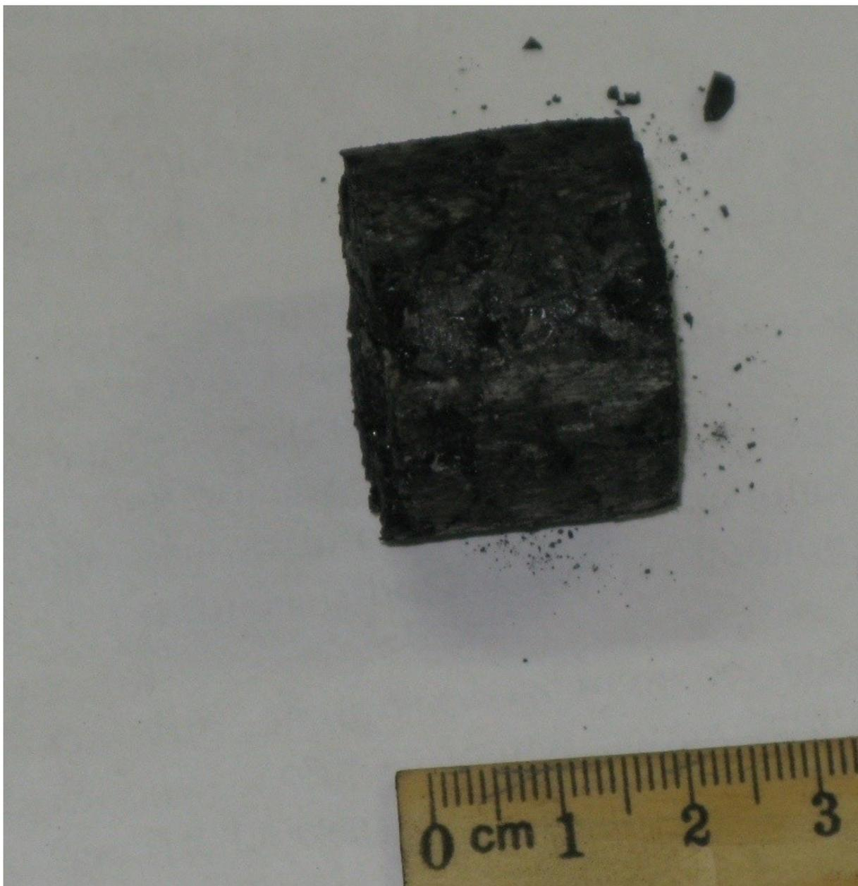
Фото 5. Брикет сарыкольского угля полученный с применением жидкого стекла (5 %). Выдержка между приготовлением смеси и процессом брикетирования 15 минут.
