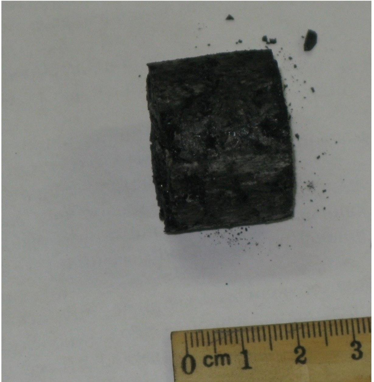
Фото 5. Брикет сарыкольского угля полученный с применением жидкого стекла (5 %). Выдержка между приготовлением смеси и процессом брикетирования 15 минут.
