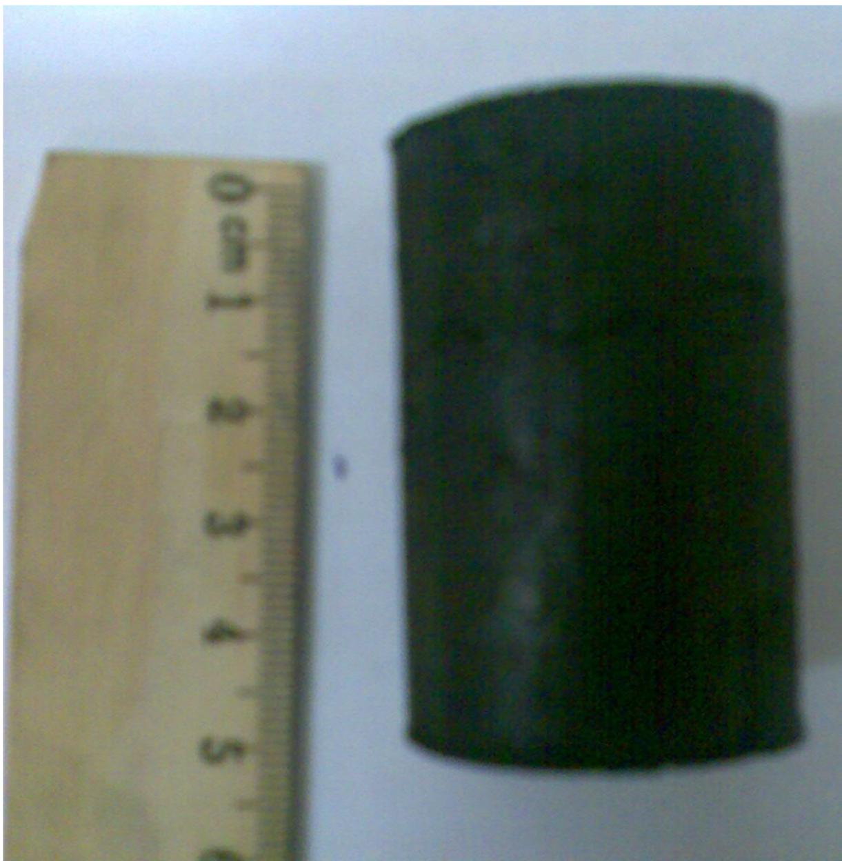
Фото 4. Брикет экибастузского угля. Высота загрузки пресс-формы максимальная (63 мм), в качестве связующего применен мазут марки 100
