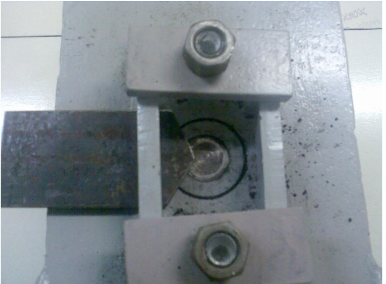
Фото 3. Пресс для брикетирования. Вид сверху. Затвор неподвижной части штемпеля, через который производится загрузка сырья.
