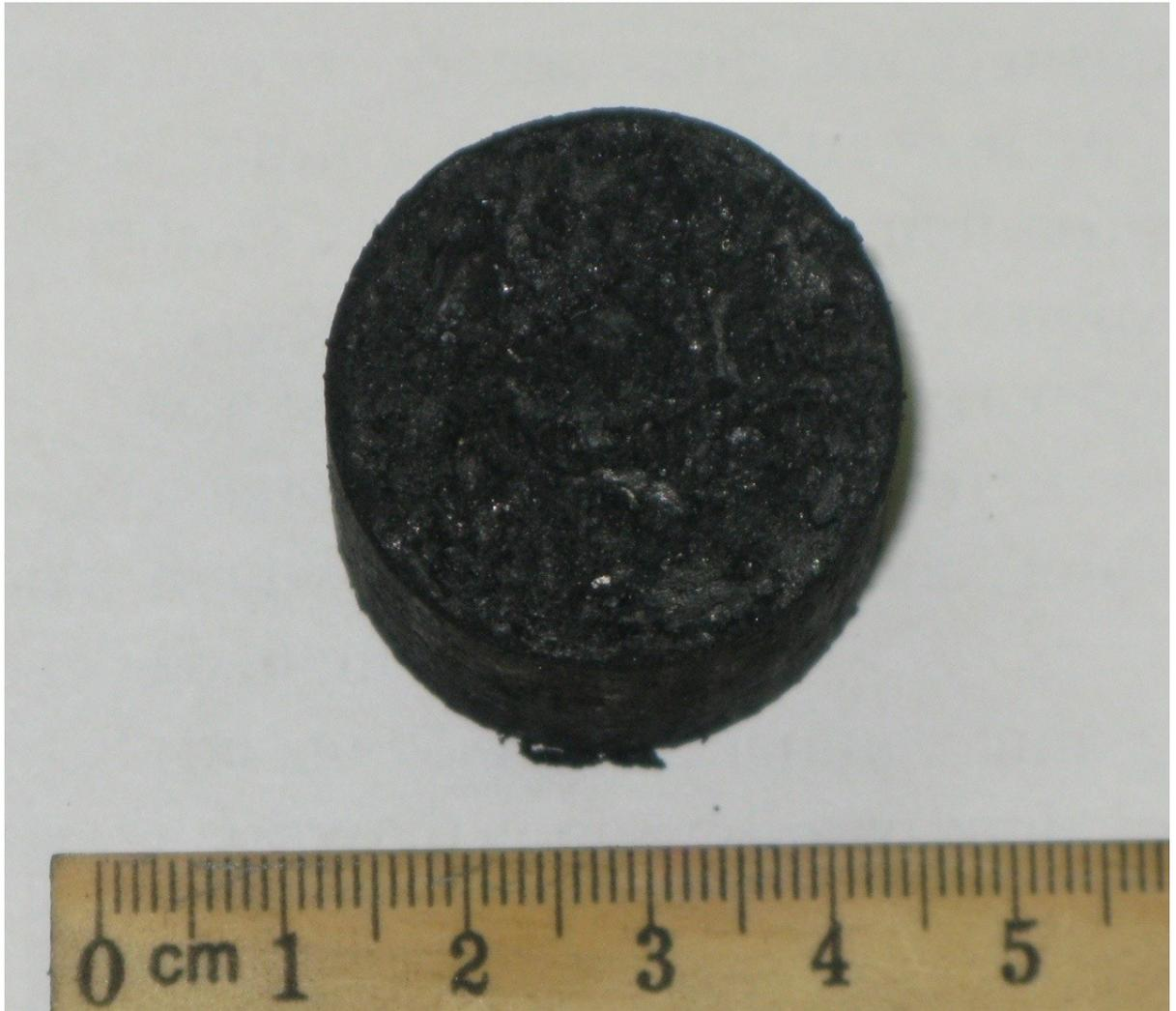
Фото 6. Брикет сарыкольского угля полученный с применением жидкого стекла (5 %) непосредственно после приготовления смеси
