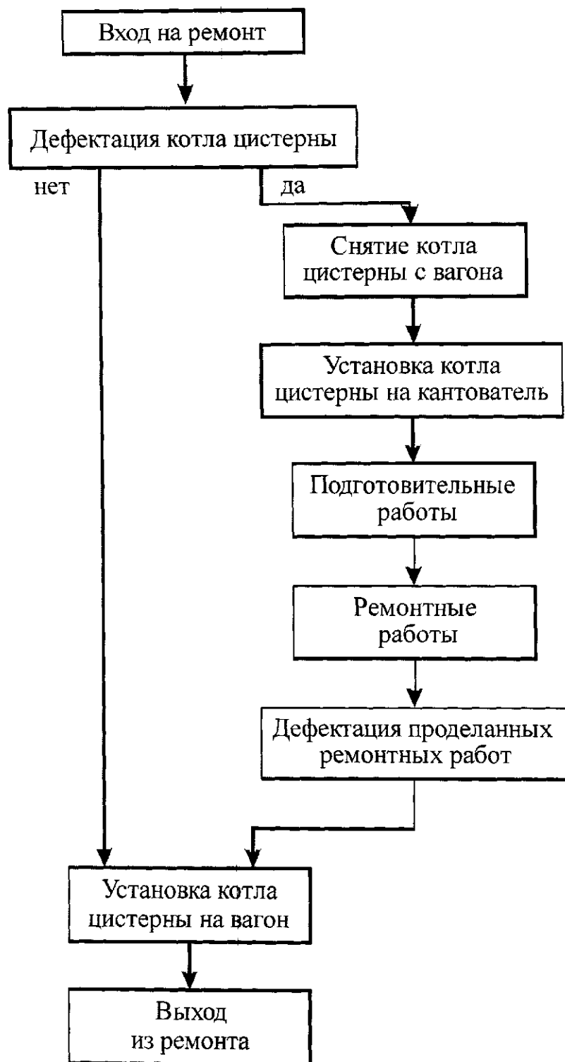
Рисунок 4 - Принципиальная схема нового метода дефектации котла цистерны
